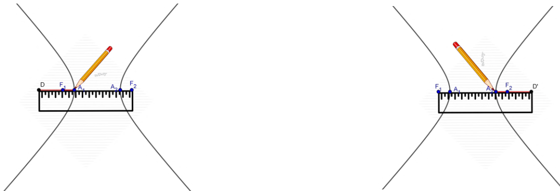
Figura 37 – Determinação dos vértices A_1 e A_2 de uma hipérbole utilizando régua e barbante
