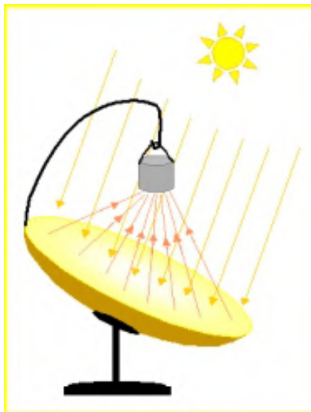
Figura 81 – Representação do funcionamento de um fogão solar parabólico
