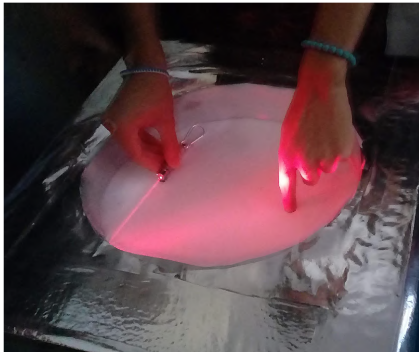
Figura 75 – Experimento de reflexão numa superfície refletora elíptica
